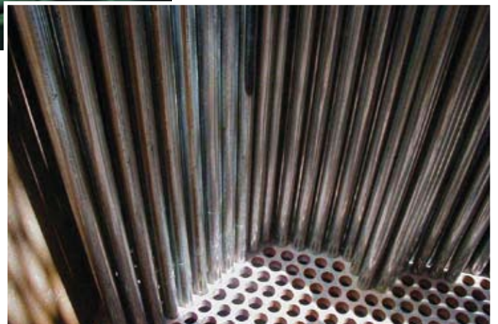
Evaporador de múltiple efecto de ingenio azucarero. Placa y tubos de ACE P444A
