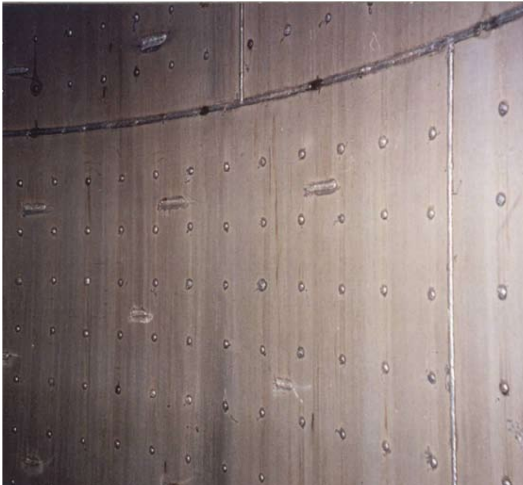
Acero 439A como revestimiento de un tacho de cocimiento de acero carbono en un ingenio después de 12 años de utilización
